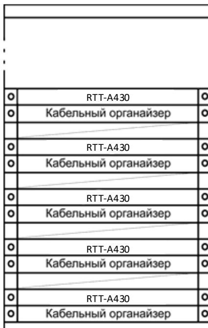
Рисунок 9 – Размещение коммутаторов в стойке
